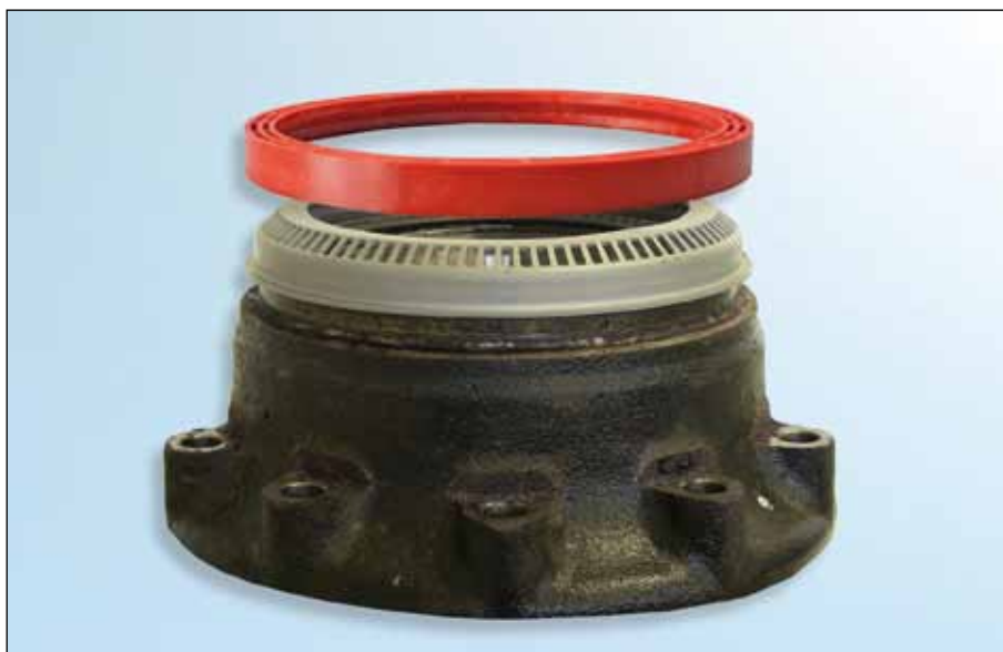
Slika 1: Montaža prstena ABS
