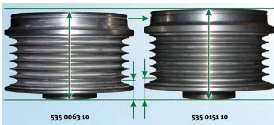
Slika 3: Razlikovanje remenica za slobodni hod alternatora INA 535 0063 10 (VALEO) i 535 0151 10 (DENSO)
