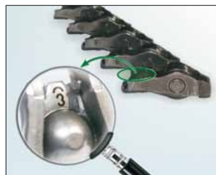
Slika 2: Oznake klackalica ventila sa valjčićima
