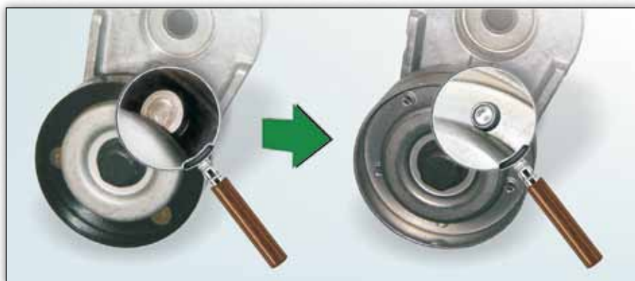
Slika 1: Detaljni prikaz klizača (rolice za izravnavanje) stare izvedbe (lijevo) i nove izvedbe (desno)
