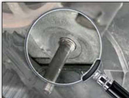
Slika 1: Vijak nije pravilno zavrnut duž cijelog navoja
