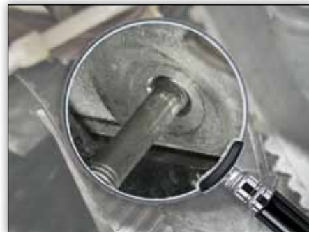
Slika 2: Vijak je pravilno zavrnut duž cijelog navoja
