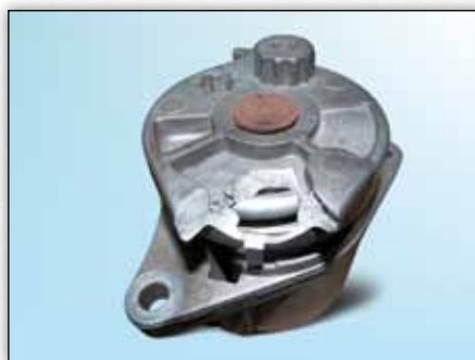
Slika 3: Primjer oštećenja jedinice natezača kat. br. 533 0017 10
