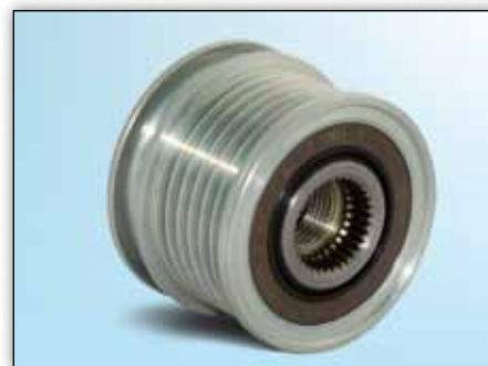
Slika 4: Remenica slobodnog hoda alternatora
