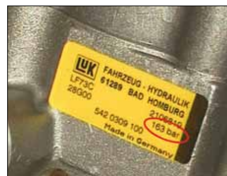
LuK crpka servo pojačivača s tlačnim redukcijskim ventilom za ograničavanje tlaka
