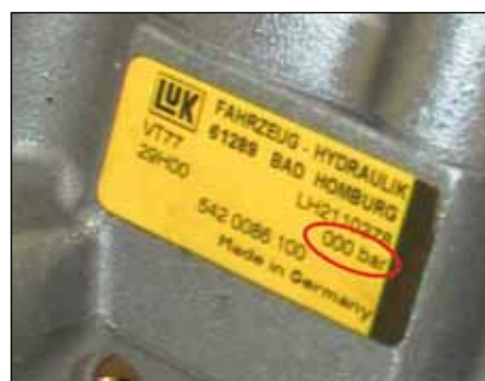
LuK crpka servo pojačivača bez tlačnog redukcijskog ventila za ograničavanje tlaka
