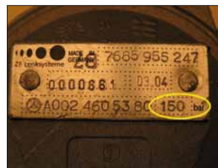
ZF crpka servo pojačivača s tlačnim redukcijskim ventilom za ograničavanje tlaka
