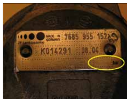
ZF crpka servo pojačivača bez tlačnog redukcijskog ventila za ograničavanje tlaka
