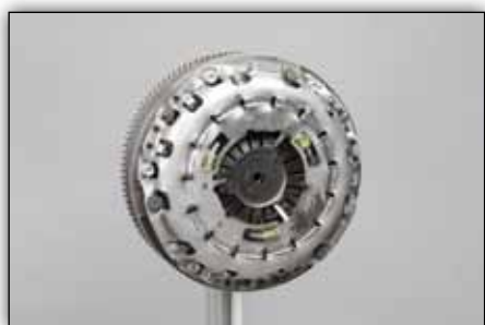
Slika 7: Pridružiti lameli spojke potisnu ploču i ravnomjerno zategnuti vijke te ih dodatno stegnuti primjenjujući moment pritezanja predviđen uputama proizvođača vozila
