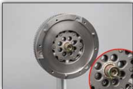
Slika 4: Prije ugradnje spojke, namjestiti centrirajuću čahuru (obratiti pažnju na ugrađeni vijak uz čahuru)
