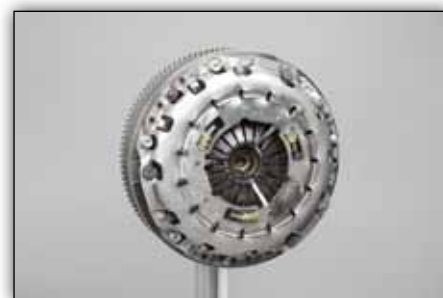
Slika 9: Skinuti centrirajuću čahuru upotrebom pripadajućeg vijka.
