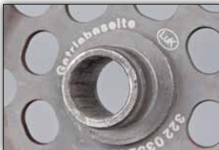
Slika 2: Oštećen uzubljeni profil
