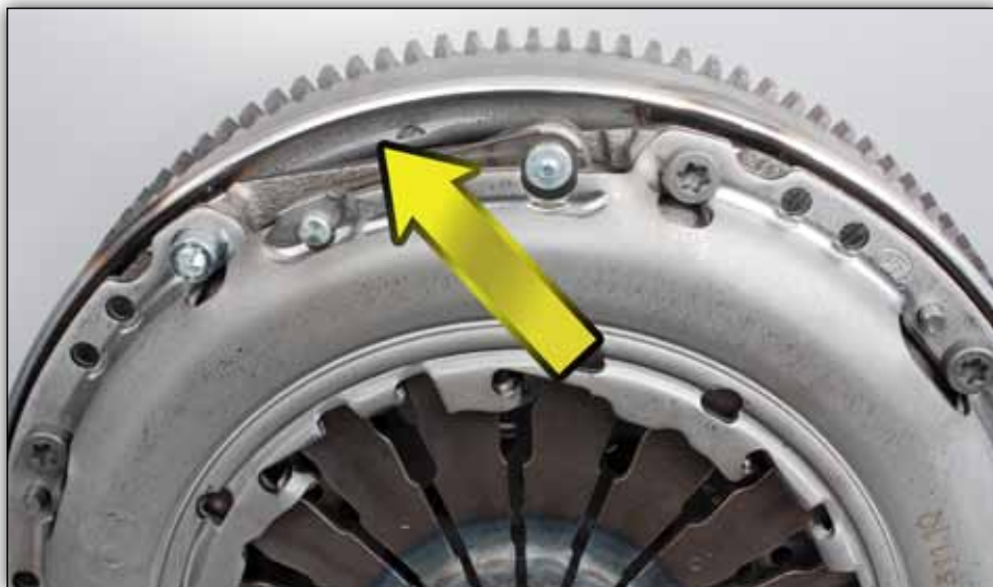
Slika 1: Oštećenje primarne mase uslijed upotrebe predugih vijaka
