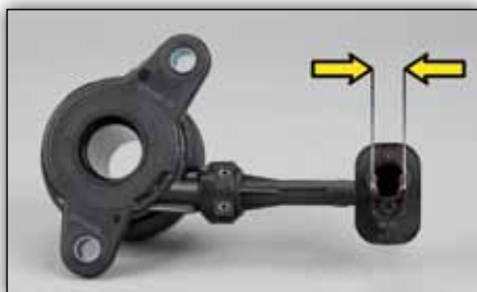
Slika 1: LuK CSC 510 0090 10 hidraulični priključak Ø 12,2 mm/Ø 13,3 mm, Ø 11,7 mm/Ø 12,2 mm
