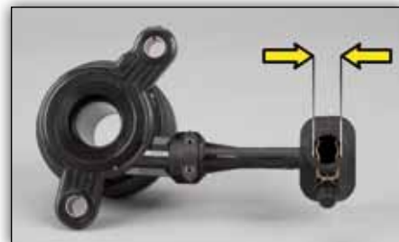
Slika 2: LuK CSC 510 0097 10 hidraulični priključak Ø 12,2 mm/Ø 13,3 mm, Ø 11,7 mm/Ø 12,2 mm
