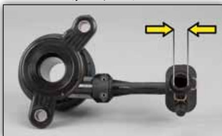
Slika 3: LuK CSC 510 0098 10 hidraulični priključak Ø 12,2 mm/Ø 13,3 mm, Ø 11,7 mm/Ø 12,2 mm
