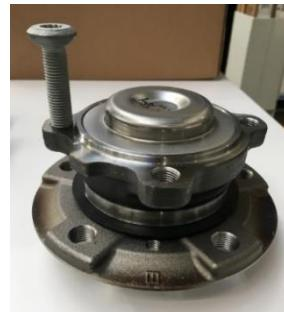
Ispitivanja i analize koje je izvršio proizvođač pokazuju da ležaj kotača možda nije pravilno pričvršćen za vozilo, što u slučaju jakog udara na kotač, na primjer u slučaju sudara, može prouzročiti djelomično ili potpuno odvajanje kotača od karoserije automobila.
