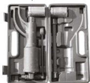
KLJUČ KOTAČA AUTOM. "RUSKI", 4200NM, PRIJENOS 58:1 SA NASTAVCIMA 32/33
