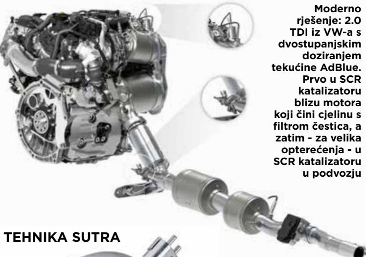
**Moderno rješenje: 2.0 TDI iz VW-a s dvostupanjskim doziranjem tekućine AdBlue.** Prvo u SCR katalizatoru blizu motora koji čini cjelinu s filterom čestica, a zatim - za velika opterećenja - u SCR katalizatoru u podvozu
