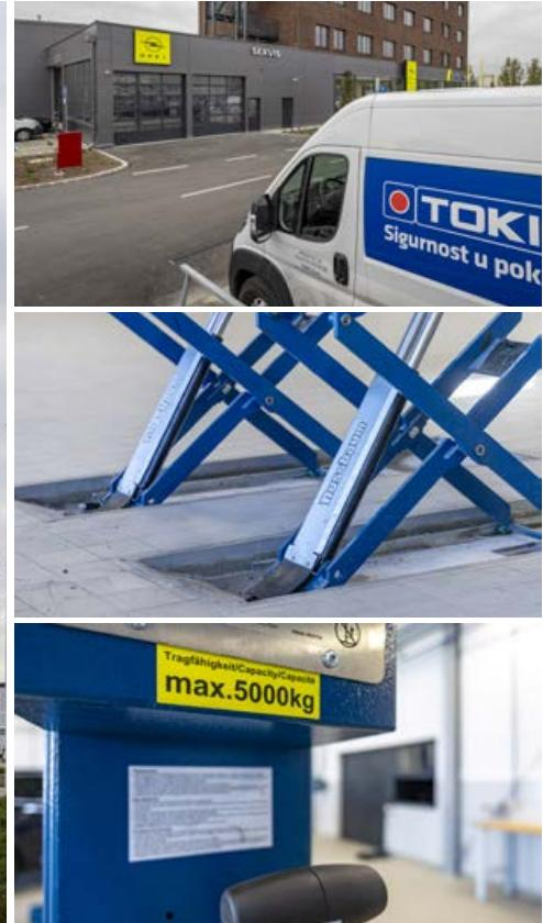
i vrhunska oprema. Radionica je opremljena najmodernijim alatima, a između ostalog i s čak devet moćnih dizalica Nussbaum, njemačkog porijekla i globalnog renomea. Pored dvije ukopne dizalice na prijemu mase do 3,5 tona, tu su i dvije škaraste jednake nosivosti, ali i jedna velika dvostupna nosivosti 5000 kg te još četiri dvostupne nosivosti po 3 i 4 tone. Takva opremljenost najbolje otkriva kapacitete i protočnost ovog novouređenog servisa. #
