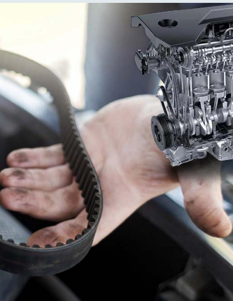
pored prednosti, donosi i svoje nedostatke. Njihova izdržljivost nije ispunila očekivanja proizvođača automobila. Trošenje ulja, nečistoće i općenito kontaminacija motora za remen
