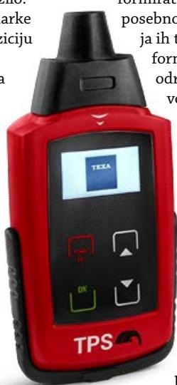
**Prosječan vijek trajanja senzora** ovisi prije svega o trajanju ugrađene baterije, koja traje od **5 do 7 godina ili oko 120.000 km**. Sam senzor jedino je ugrožen pri montaži i demontaži guma, zbog mogućnosti mehaničkog oštećenja alatima za zamjenu guma. Izuzeće može biti prohrđavanje metalne varijante senzora na vanjskom dijelu koji je izložen vlazi i soli, ali neki proizvođači tada koriste kućište koje se može posebno zamjeniti bez zamjene kompletног senzora
