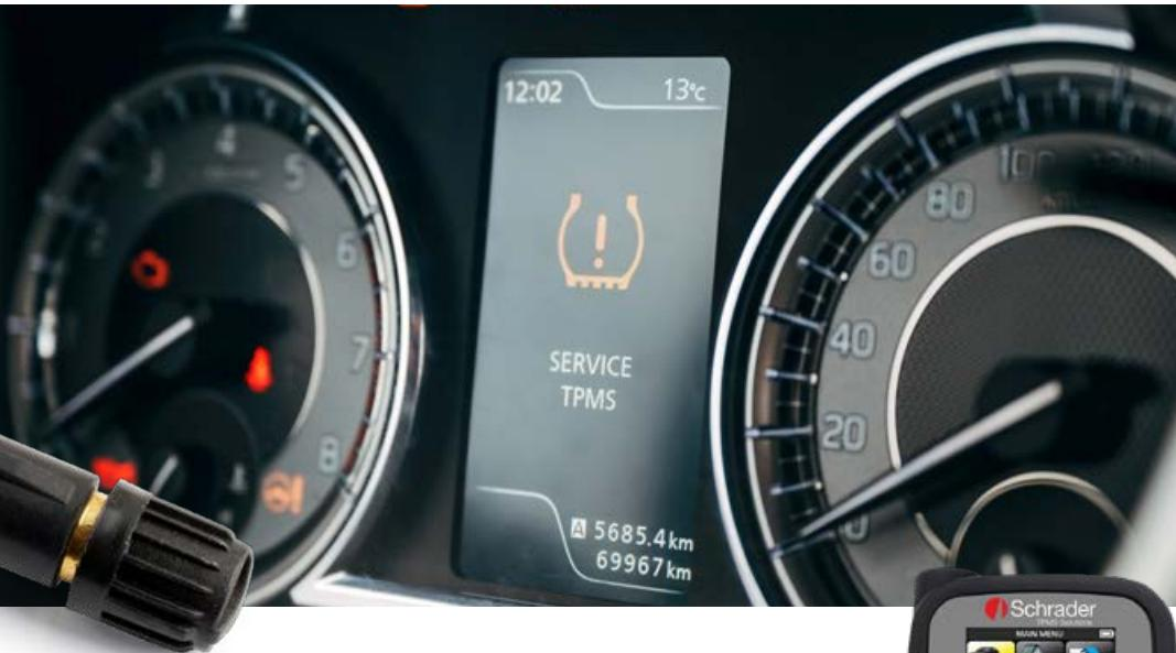
mjere tlak, temperaturu, stanje baterije te imaju jedinstveni ID broj za identifikaciju. Ako se baterija isprazni, cijeli senzor mora se zamjeniti jer baterija nije zamjenjiva.
