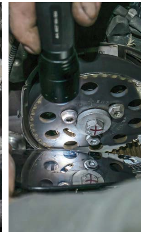
...u gornjoj mrtvoj točki s pomoću za to propisanih alata. Nijedan dio motora se ne smije pomaknuti bez remena. Fotografija pokazuje zamjenu klasičnog, suhog zupčastog remena
