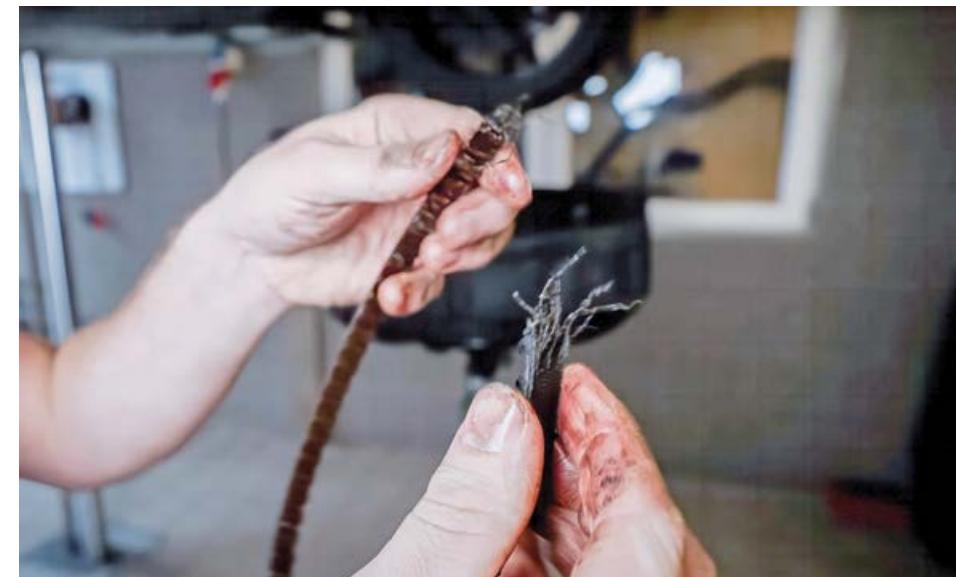
Puknuti remen za pogon uljne pumpe jednog VW-ova TDI-motora. Trajni kontakt s uljem nagrizava materijal remena
