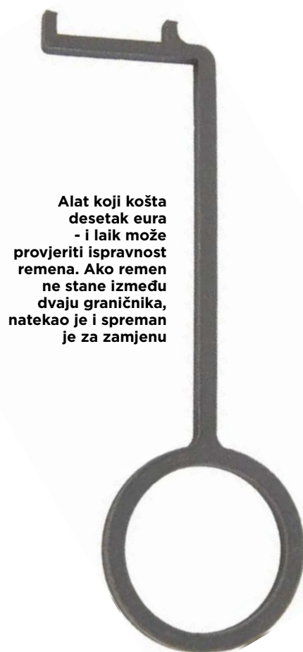
Otvor za dolijevanje ulja na 1,2 PureTech-motoru omogućuje pogled na razvodni remen. Tu se može umetnuti alat (gore) za provjeru ispravnosti remena
