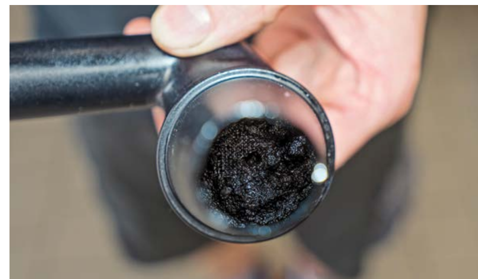
Opasnost na usisu - uljna pumpa usisava ulje u kojem pluta smeće i ono se taloži na situ te tako blokira protok
