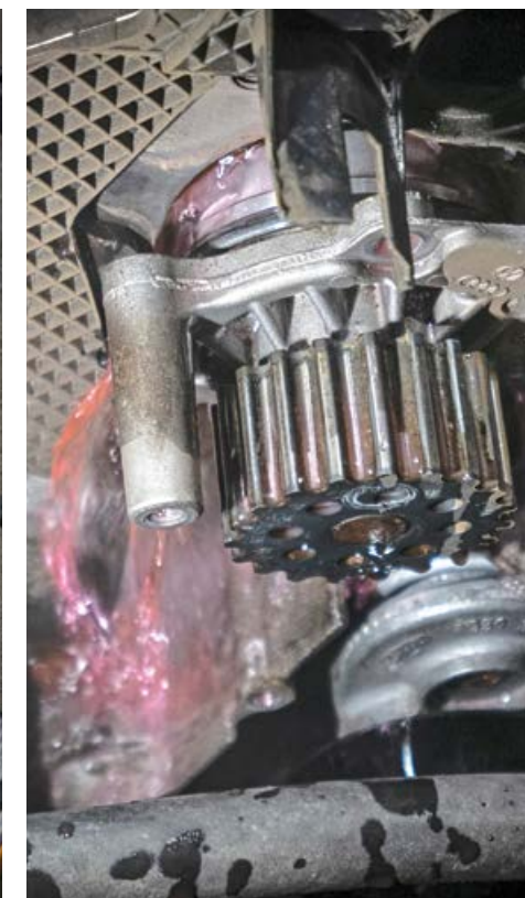
Kod svih motora je prije zamjene remena potrebna demontaža poklopca i štitnika te praznjenje rashladnog sustava. Neizbježan korak je fiksiranje radilice i razvodnog mehanizma...
