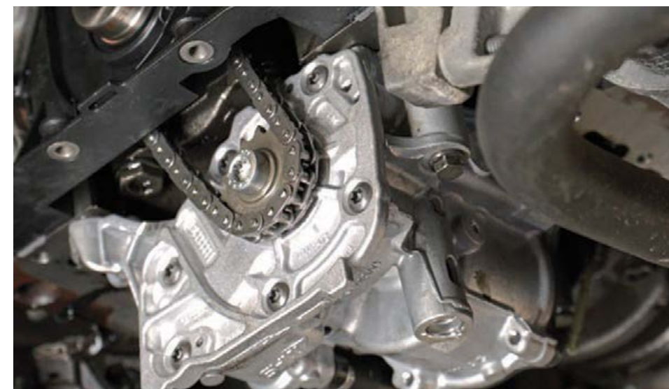
Više nije opasna točka - zamijenjena uljna pumpa s lančanim prijenosom od MIK-a kao zamjena za zupčasti remen
